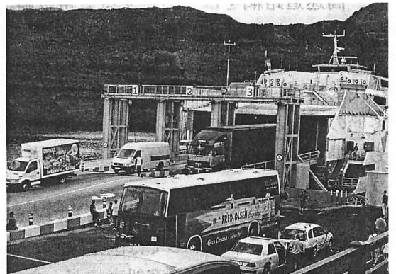
3車線を使った効率的な荷役を行い、3分間で車両を下ろす96m型高速双胴カーフェリー
